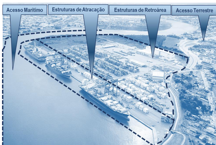
Figura 1 – Subsistemas Portuários – Foto Terminal Privado Portonave, Navegantes – SC. Disponível em < http://www.portosmercados.com.br/wpcontent/uploads/2016/04/arq_2822_102467.jpg > Acesso em 05/11/2016
